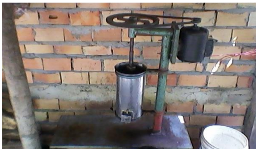
Figura 10 — Máquina elétrica de ‘bater’ açai.
